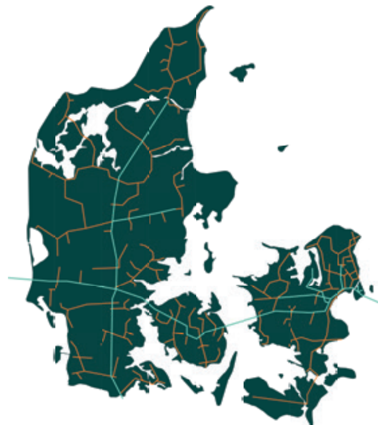
Figur: Distributionssystemet dækker med sine 18.000 km rør det meste af Jylland, Fyn og Sjælland. I 2024 blev det udvidet til Lolland-Falster.
